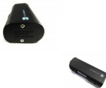
Мод с електроника на Evolv DNA75. Изходна мощност 75W, една батерия 18650, капак на магнити.
